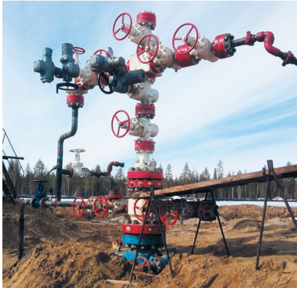
Фонтанная арматура производства ВМЗ
